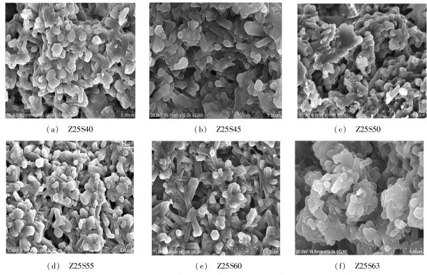
图 2 不同固含量试样的 SEM 微观形貌
