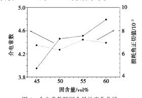
图 4 介电常数随固含量的变化曲线
