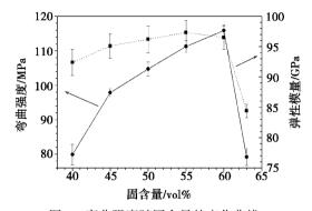
图 3 弯曲强度随固含量的变化曲线
