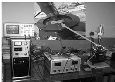
图9 超声辅助电加工试验系统
