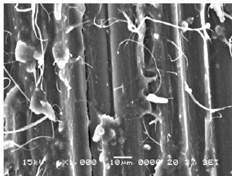
(b) 拉伸试样断口微观形貌
