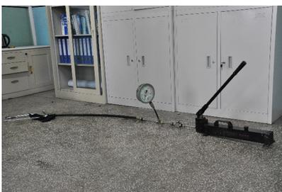
图8 耐压试验安装示意图
