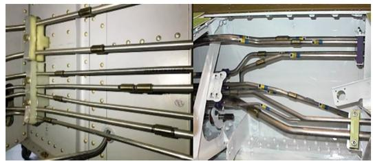
图1 运12F飞机液压系统应用记忆合金接头技术
