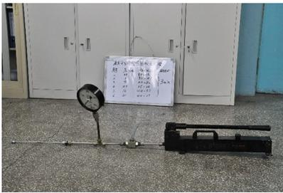
图6 外径为Φ6 mm的试验件安装
