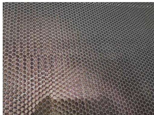
图9 胶膜热破完成后的芯格照片
