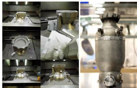
图9 采用3D打印技术制造的主要氧化剂阀门
