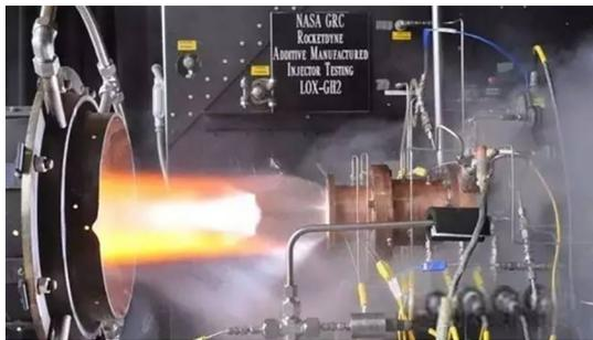
图6 增材制造的 mini-Banton 发动机进行点火测试
