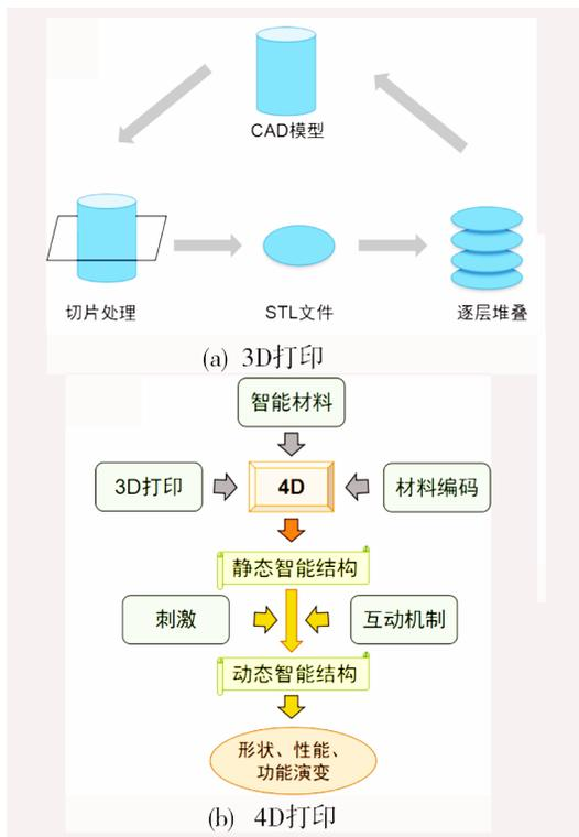
图1 3D打印与4D打印示意图
