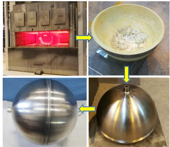
图1 冷氦气瓶成形工艺流程图
