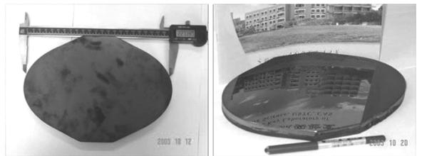
图 11 PIP-CVI 联用制备的 200 mm 口径的 C/SiC 复合材料反射镜
