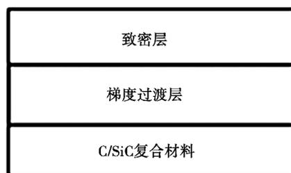
图 2 C/SiC 反射镜表面结构示意图
