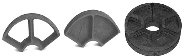
图 4 C/SiC 反射镜素坯块及连接后的整体素坯
