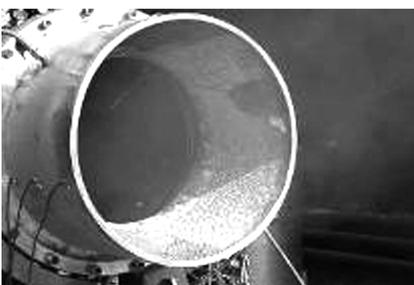
图 3 C/C-SiC 燃烧室和喷管及热试车
