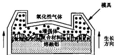
图1 RMI制备复合材料示意图
