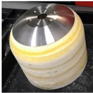
图2 PVP/石英砂水溶性芯模
