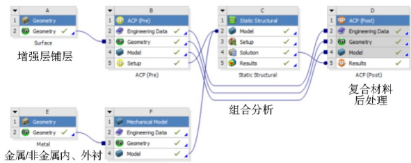
图7 碳纤维复合材料作动器仿真过程图 Fig. 7 Simulation process of the carbon fiber actuator
