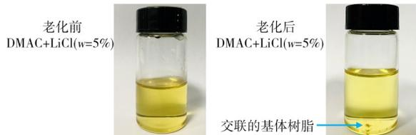
图 12 基体树脂在添加 LiCl ( $w_{LiCl}=5\%$ ) 的 DMAC 中的溶解性
