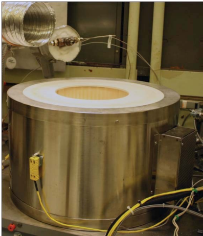
图 21 高温气密性测试平台
