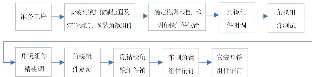
图4 角镜组件装配流程图
