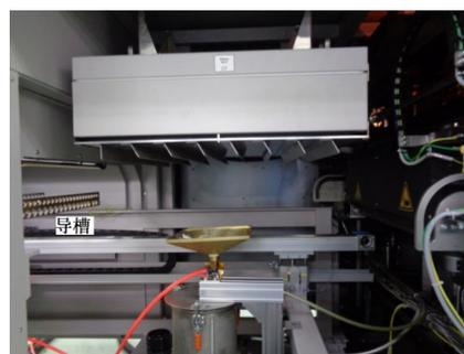
图2 改造后的真空汽相焊冷却区
