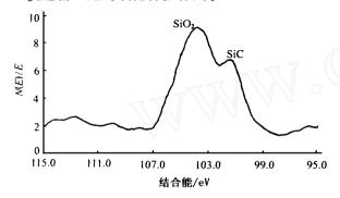
图 6 试样烧蚀后表面能谱中 Si 元素的 XPS 谱图 Fig. 6 XPS analysis of the ablated surface of C/C and C/C SiC composites
