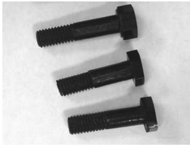
图 1 模压制得的螺纹紧固件
