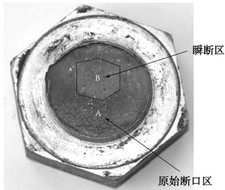
图 2 断口整体形貌
