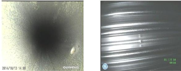
图9 不锈钢导管凹坑、凸起
