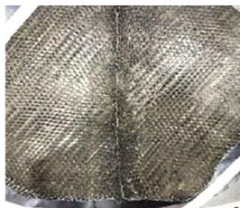
图7 反射面上蜂窝芯拼接试样
