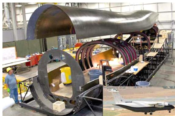
图 3 MTM45-1 材料用于 ACCA 大型整体化机身结构
