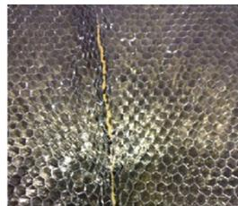
图8 固化后的反射面上蜂窝芯拼接
