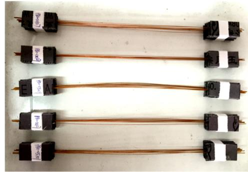
图7 PBO复丝宏观形貌
