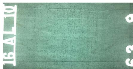
图5 63 kV, 9 mA·min 像质计影像
