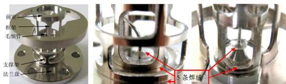
喷注器结构 下部3条焊缝 上部2条焊缝
